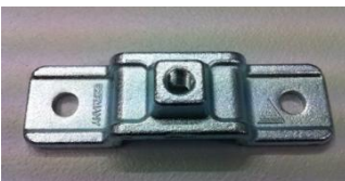
Rungen- od. Seitenwandhalter ohne Schraube, Guss verzinkt Länge 100mm, Breite 33mm, U-Vertiefung 32x11mm Schraubenabstand 80mm
