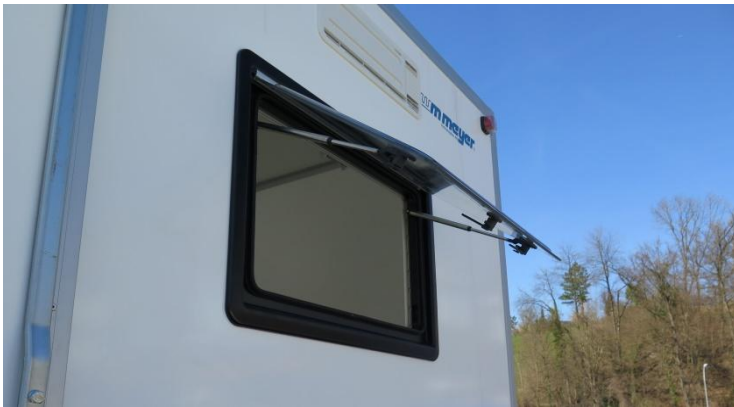
geöffnetes Fenster hält mit Hebedämpfer
