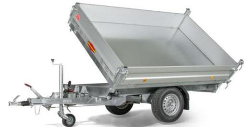
DK-AL 2516/18 Alu Pendelklappe Stahlblechboden
