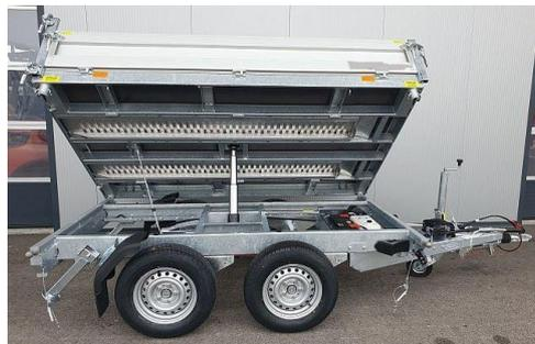
Rampen in Rampenfach Kurbelstütze
