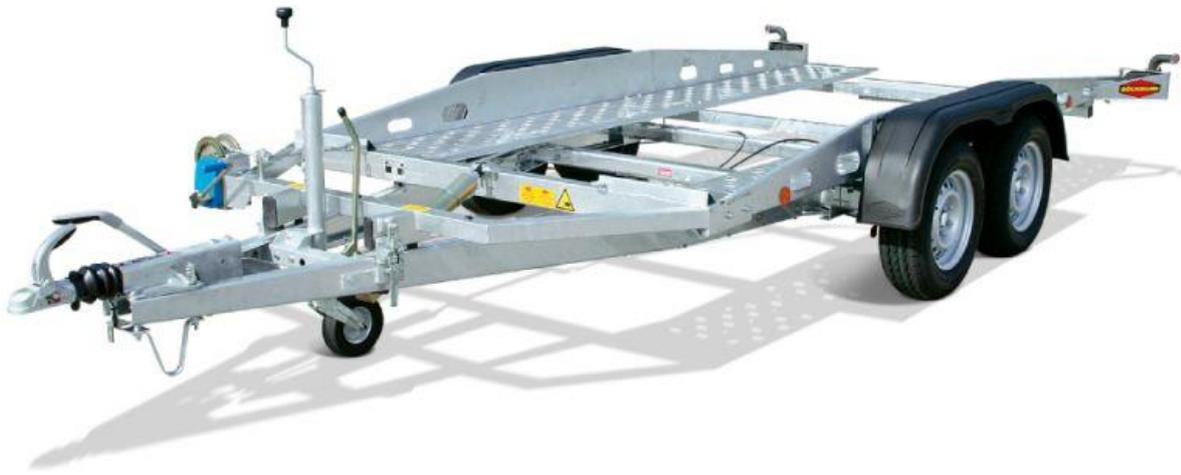
**AT 4019/27 400 x 194cm, Kippvorrichtung mittels Handhydraulikpumpe**
