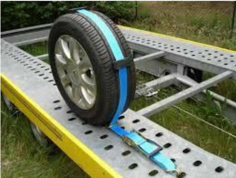
**Löcher in der Lauffläche für Radsicherungsgurte**
