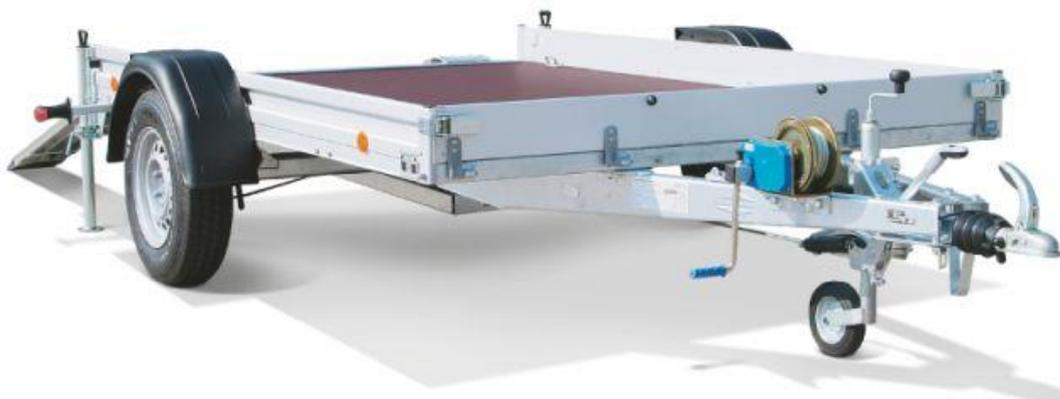
**Stahlauffharrampen unten einschiebbar, Handseilwinde auf Deichsel**
