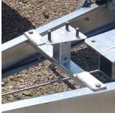
Ersatzradhalter zu Pongratz L-AT 400 für Befestigung auf Deichsel für Autotransportanhänger Pongratz Miet-Lift Art. 42209
