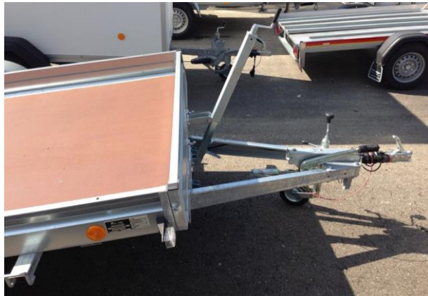
Spindelkurbel zum Heben und Senken der Brücke
