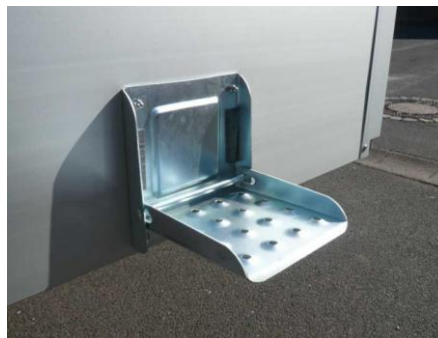
Klapptritt an Heckwand montiert
