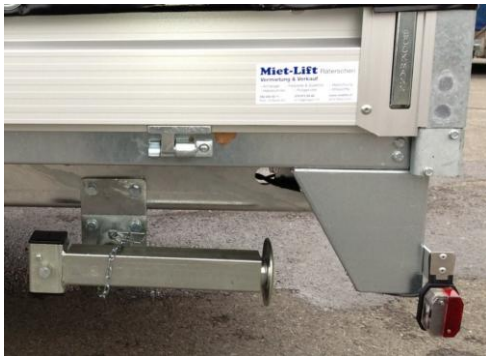
Kurbelstütze, Traglast 1200kg, abschwenkbar
