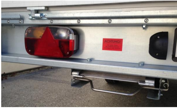
Rampen unter Brücke mit Sicherungsbügel
