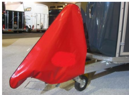
Schutzhaube über Stützrad und Kupplung
