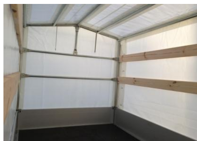
Innenansicht Blachenaufbau Innenhöhe 180cm
