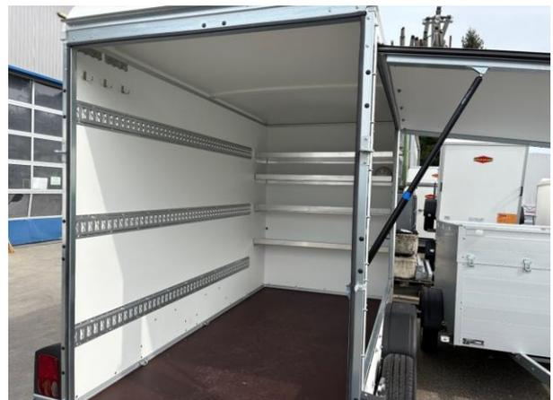
**Werkzeughänger mit Kombirampe, Seitenklappe, 3 Schienen für Zurrgurte und Werkzeughalter, 4 Aluminiumtablare**
