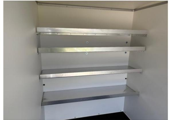
**Werkzeughänger, hinten 2 Flügeltüren, 3 Schienen für Zurrgurte und Werkzeughalter, 4 Aluminiumtablare**
