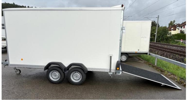
**Werkzeughänger, hinten Kombirampe, 3 Schienen für Zurrgurte und Werkzeughalter**
