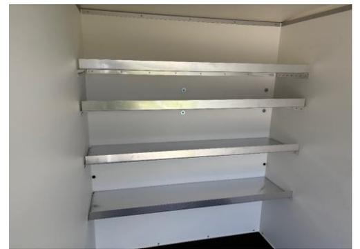
**Werkzeughänger, hinten Kombirampe, 3 Schienen für Zurrgurte und Werkzeughalter, 4 Aluminiumtablare**
