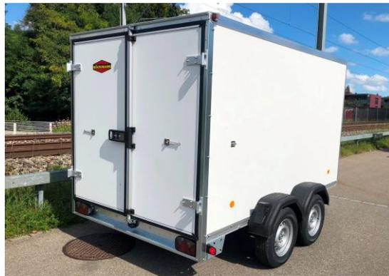
**Werkzeughänger, hinten 2 Flügeltüren, 3 Schienen für Zurrgurte und Werkzeughalter**
