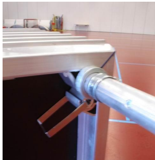
Klemmbügel geschlossen mit eingestecktem Fuss
