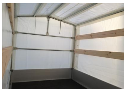
Innenansicht Blachenaufbau Innenhöhe 180cm
