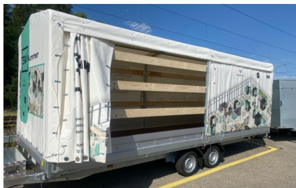
Blachenaufbau mit Schiebeblache, HL-AL 6221/35 Blachenbeschriftung auf Anfrage
