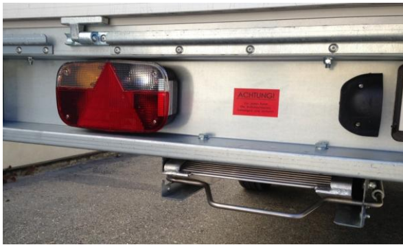
Rampen unter Brücke mit Sicherungsbügel
