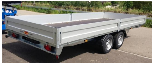
ab 514cm Länge mit geteilten Wände, Mittelposten
