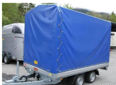
Blachenaufbau mit Schiebeblache, HL-AL 6221/35 Blachenbeschriftung auf Anfrage
