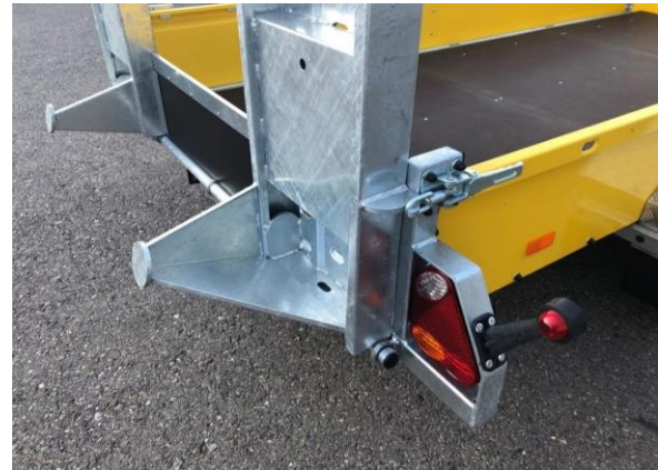
integrierte Abstützung in Rampe
