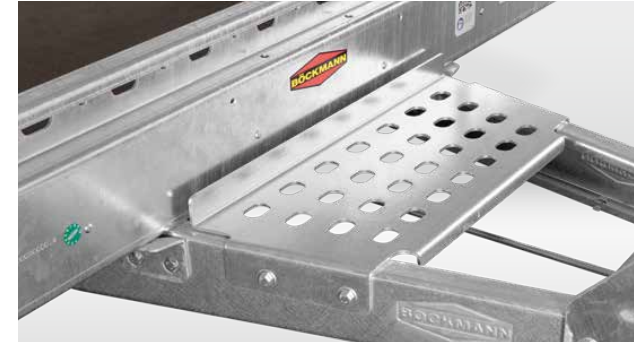
Schaufelablage vorne am Anhänger, für das komfortable und sichere Verstauen der Schaufel während des Transports.
