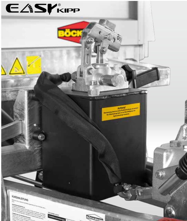
EasyKipp Hydrauliksystem (nur MH-Modelle) für das Kippen der Oberbrücke per Akkuschauber.
