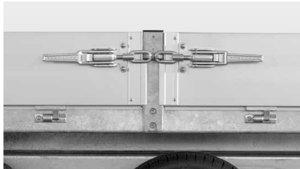
Mittelrunge (nur MH-Modelle) sorgt für geteilte Bordwände auf beiden Seiten des Anhängers. Pflichtoption bei der Auswahl einer Plane und Spiegel Konstruktion.
