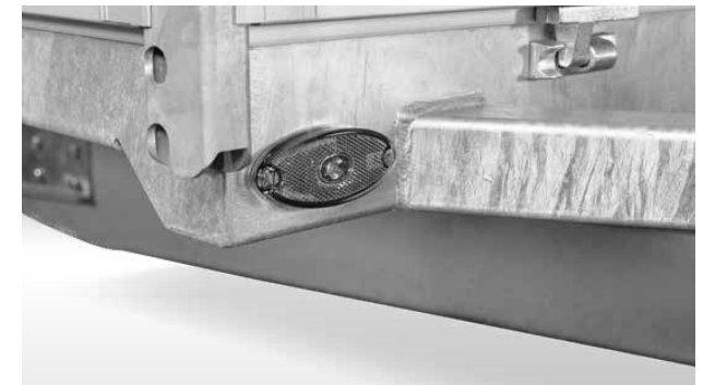
Optimal angebrachte LED-Beleuchtung um vom Zugfahrzeug aus die maximale Fahrzeugbreite im Blick behalten zu können. Optional Rückleuchte auch als LED-Beleuchtung erhältlich.
