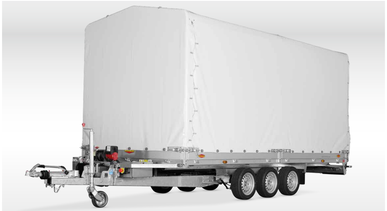
Plane und Spiegel (nur MH- und TL-ALK-Modelle) um Fahrzeuge, Maschinen oder andere Güter geschützt zu transportieren (für die MH-Modelle auf Anfrage erhältlich). Die Planen gibt es in vielen unterschiedlichen Farben. Auch eine individuelle Beschriftung ist möglich, Ihr Böckmann Partner vor Ort berät Sie gerne!
