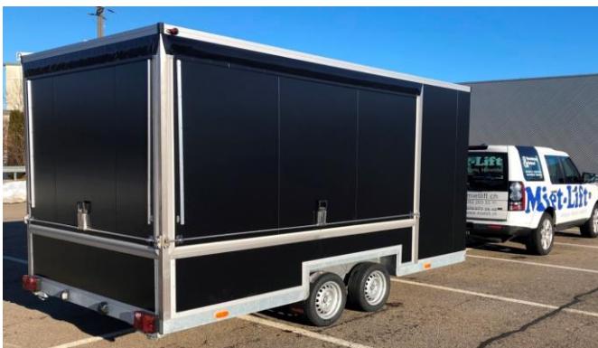
Hochlader mit eingebauten Rädern, 3 Seitenklappen
