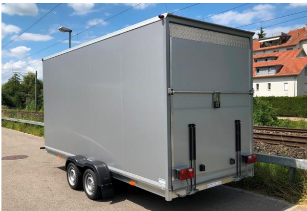
TT-Heckrampe aus Aluminium, Tragkraft 1200kg
