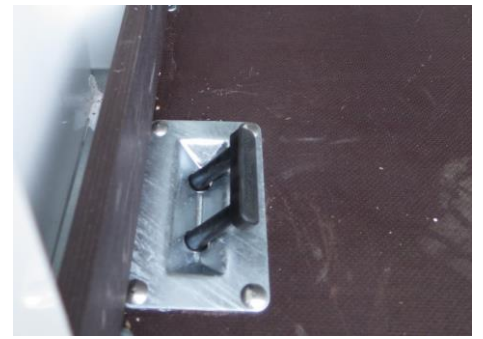
Bindebügel im Boden versenkt
