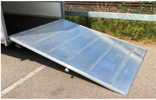
Standard-Alurampe mit geschlossenem Scharnier, Keil
