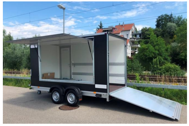
Seitenklappe, Personentüre, Heckrampe mit Überfahrblech
