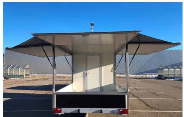
Kofferaufbau geteilt, vorne Lagerraum mit Türe
