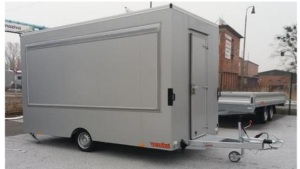
Starker Profi-Anhänger für Gewerbe- und Berufsfahrer. Verschweisstes, verzinktes und verschraubtes Fahrgestell. 1-Achser mit Gummifederachsen, Auflaufbremsen mit Rückfahrautomatik, automatisches Stützrad, 50mm Kugelkupplung. 2 Radkeile, Beleuchtung im Lichtbalken geschützt, 12 Volt mit 13-poligem Stecker. Für 100 km/h zugelassen
