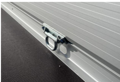
Verstellbare Zurrbügel links und rechts in Nutenprofil
