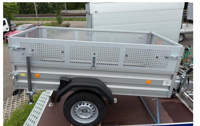
Stahlblechaufsatz 4-seitig + 35cm
