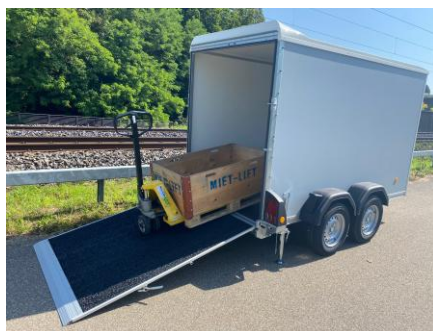
Kombirampe: Rampe auch als Türe zu öffnen, Silikonbelag
