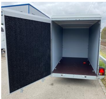
Kombirampe: Rampe auch als Türe zu öffnen, Silikonbelag
