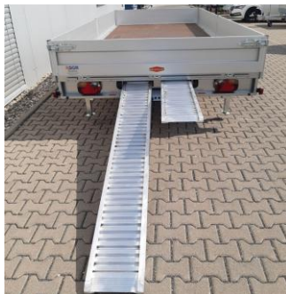
Alurampen unten einschiebbar Blachenaufbau
