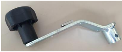
Kurbel zu Stützrad, Innendurchmesser 17mm, verzinkte Kurbel, Hebellänge ca. 150mm, Splintlochgrösse 6mm
