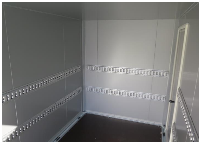
Sandwichwände Stahlblech 30mm mit 2 Reihen Loch-Schlitzzurrschienen weiss oder silber-grau
