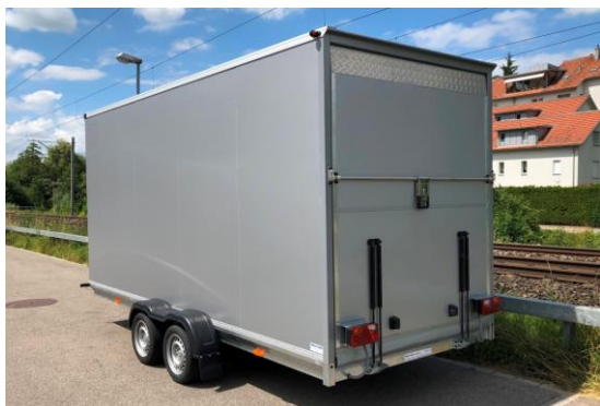
Heckrampe aus Aluminium, Tragkraft 1000kg
