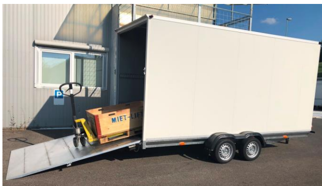
450 x 178 x 220cm mit Rampe 220cm Länge mit Paettenwagen befahrbar
