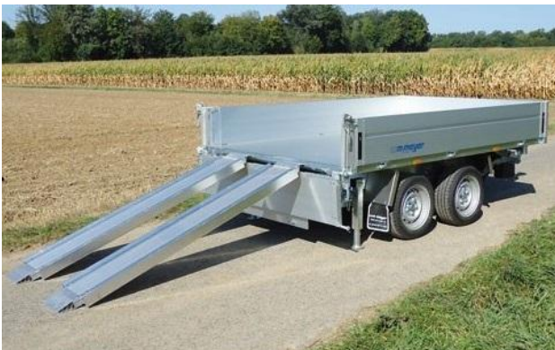
Aluauffharrampen in Rampenfach gelagert
