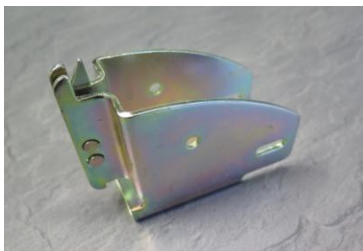
Balkenschuh zu Loch-Schlitzschiene Nr. 58100, Stahl verzinkt Innenbreite 43mm, Innenhöhe 70mm Innenmass Ausladung 86mm Miet-Lift Art.Nr. 58114
