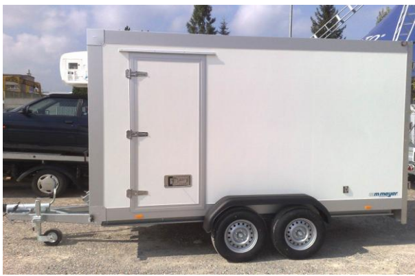
Tiefkühlanhänger mit Seitentüre, 100mm Isowände
