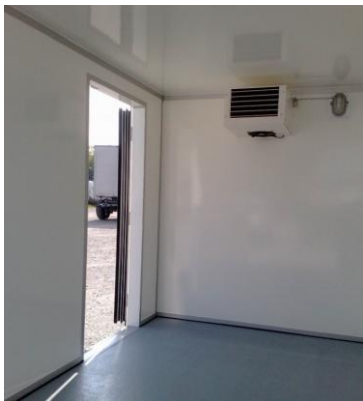
Tiefkühlanhänger mit Seitentüre, 100mm Isowände
