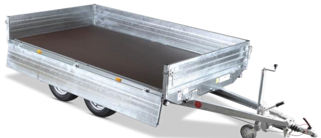
HL-ST mit feuerverzinkten Stahlwände
