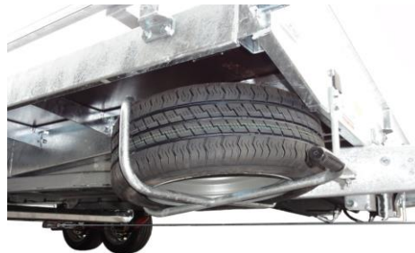
Ersatzrad unter Brücke montiert
