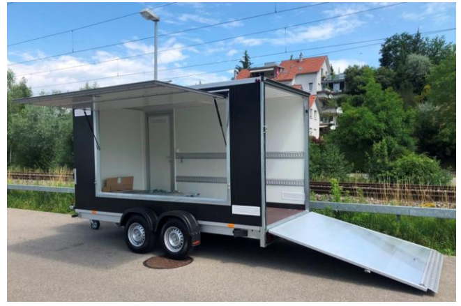
Seitenklappe, Personentüre, Heckrampe mit Überfahrblech
