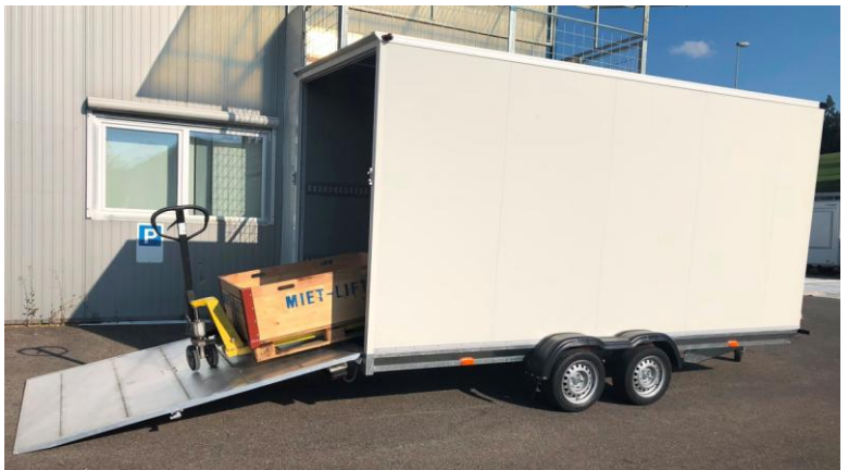
450 x 185 x 220cm mit Rampe 220cm Länge mit Paettenwagen befahrbar
