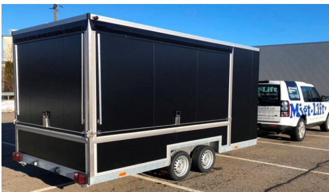
Hochlader mit eingebauten Rädern, 3 Seitenklappen
