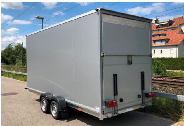
TT-Heckrampe aus Aluminium, Tragkraft 1200kg
