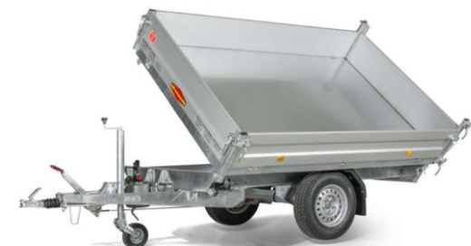
DK-AL 2516/18 Alu Pendelklappe Stahlblechboden
