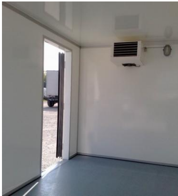
Tiefkühlanhänger mit Seitentüre, 100mm Isowände
