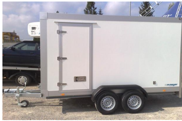
Tiefkühlanhänger mit Seitentüre, 100mm Isowände
