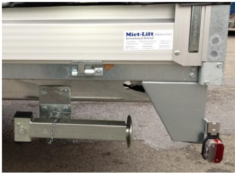
Kurbelstütze, Traglast 1200kg, abschwenkbar
