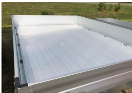
Aluminiumprofilboden statt Holzboden
