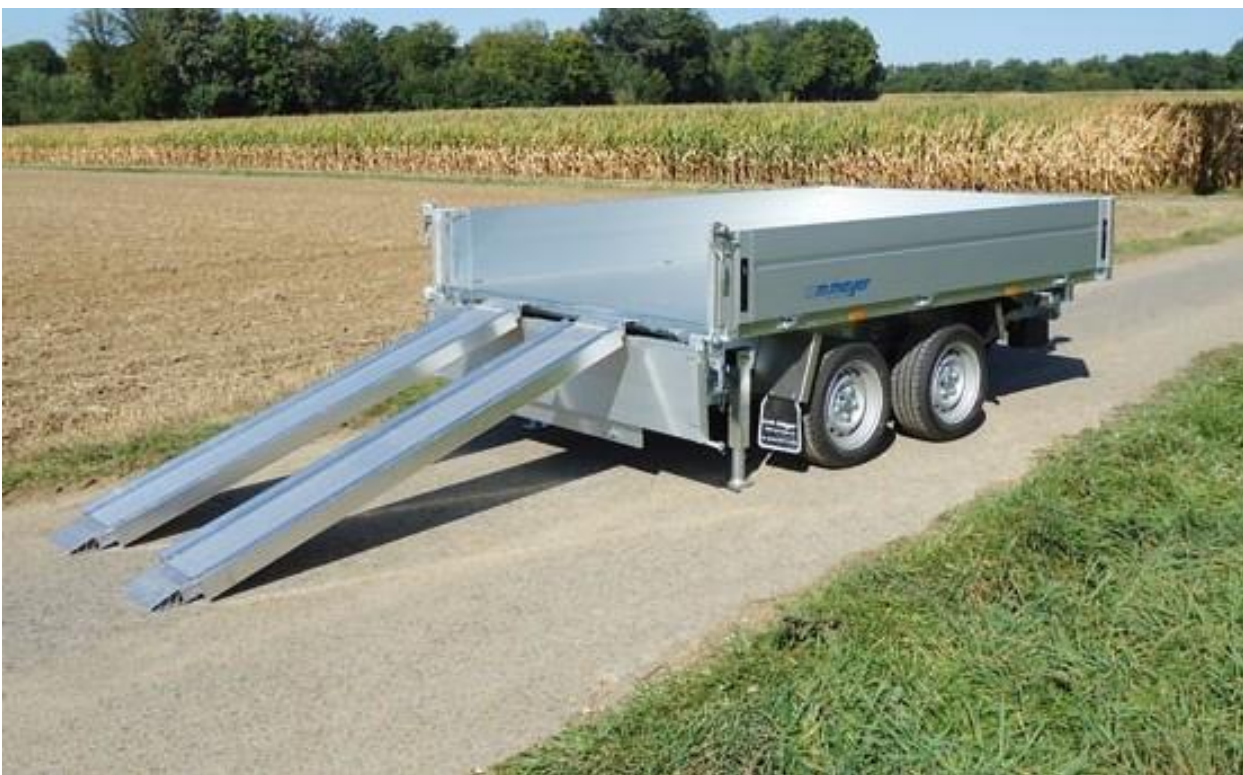
Aluauffahrampen, unter der Brücke gelagert, Abdrehstützen
