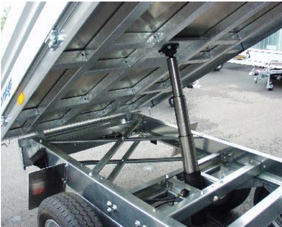
Brücke Stahl verschweisst feuerverzinkt, Chassis verschraubt galvanisch verzinkt
