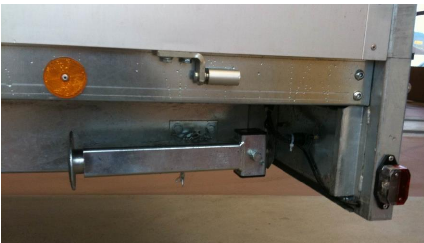
Abdrehbare Kurbelstützen seitlich am Längsträger angebracht
