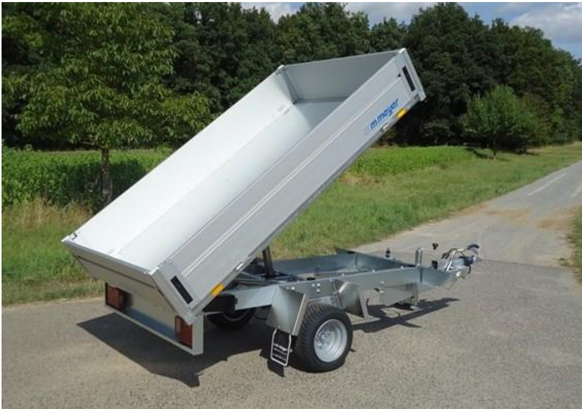
Rückwärtskipper HLNK 1527/151, 269 x 151 x 33cm, Handpumpe, Aluminiumbordwände
