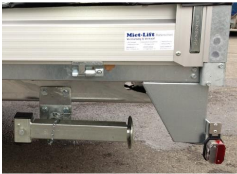
Kurbelstütze, Traglast 1200kg, abschwenkbar
