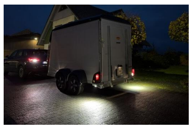
Umfeldbeleuchtung mit zusätzlichen LED Scheinwerfer
