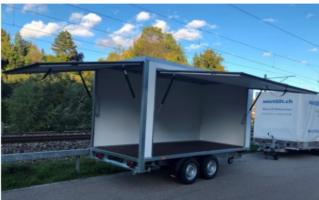
KH 3221 mit Niederfahrwerk, 2 Ausstellklappen
