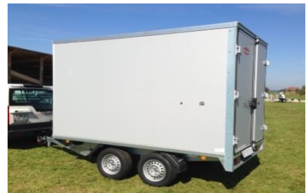
KH Hochlader Plywoodwände, Alu- oder Sandwichdach
