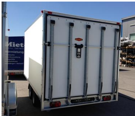
Hochlader mit Heckrampe, Hebehilfen
