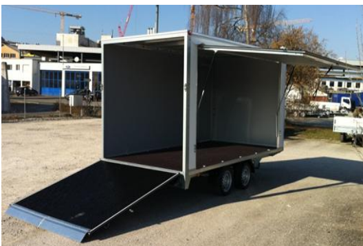
Rutschfester Silikonbelag, Anfahrblech, Seitenklappe
