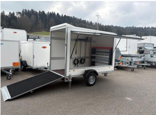
Werkzeuganhänger mit Rampe, Seitenklappe, Schienen und Werkzeughalter, Karettenhalter, Lagergestell Würth, Tablare Weitere Möglichkeiten mit Trennwand und Seitentüre für Büro/Pausenraum mit Fenster und Tisch/Bank
