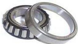
**Kegel-LM-Radlager, Aussendurchmesser** 45,3mm, Innendurchmesser 19mm, Gesamtdicke aussen 17mm, Dicke Aussenring 12mm
