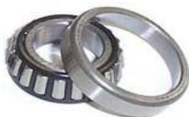
**Kegel-Rollenlager für Bremstrommeln** Nr. 30205, Aussendurchmesser 52mm Innendurchmesser 25mm, Dicke 17mm Alko 702317.
