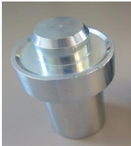
**Einschlagwerkzeug für Radlager 39/72**
