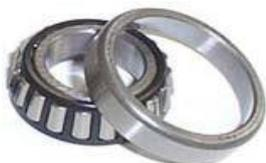
**Kegel-Rollenlager für Bremstrommeln** Nr. 30204, Aussendurchmesser 47mm Innendurchmesser 20mm, Dicke 16mm
