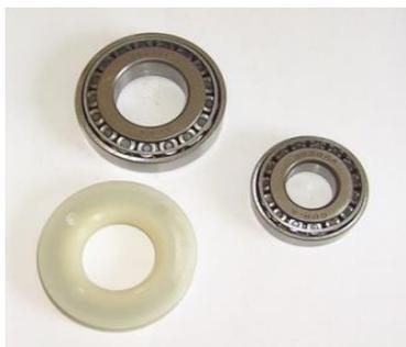
**Kegel-LM-Radlagersatz Knott mit Dichtung**, Typ Nieper 250x40, Lagerpaarung 30205 (52x25x17mm) + 30207 (72x35x18mm), Dichtring (35x72x5mm)
