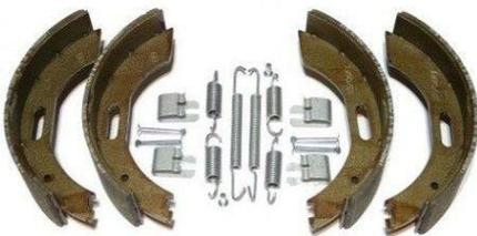
**Bremsbackenset für 1 Achse 200x50mm**
