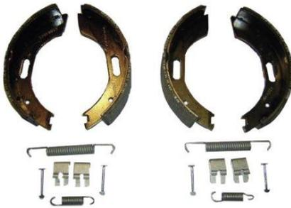
**Bremsbackenset für 1 Achse 250x40mm**
