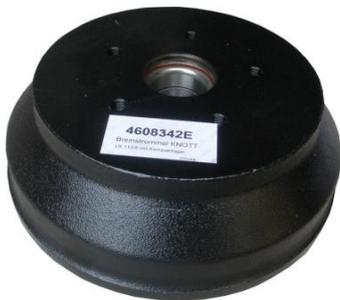
**Knott Bremstrommel, Kompaktlager**
