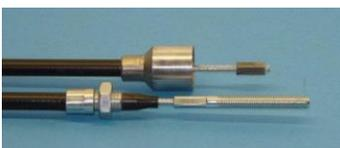
**Bremseil KNOTT Bremssystem**
