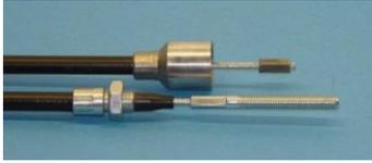
**Bremseil KNOTT Bremssystem**
