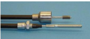
**Bremseil KNOTT Bremssystem**
