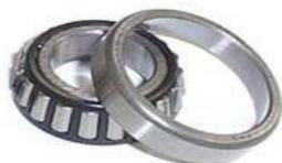
**Kegel-Rollenlager für Bremstrommeln** Nr. 30206, Aussendurchmesser 62mm Innendurchmesser 35mm, Dicke 18mm
