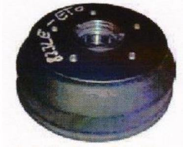
**Knott Bremstrommel, Kompaktlager**
