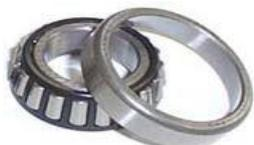
**Kegel-Rollenlager für Bremstrommeln** Nr. 30207, Aussendurchmesser 72mm Innendurchmesser 30mm, Dicke 17mm
