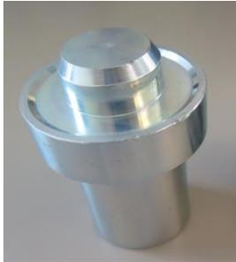
**Einschlagwerkzeug für Radlager 34/64**
