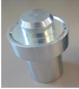
**Einschlagwerkzeug für Radlager 30/60**
