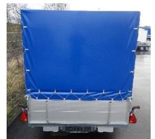
**Motorradanhänger**, robuster verzinkter Unterbau, 2 Motorradstandschiene, 1 Auffahrschiene (3.Standschiene kann erweitert werden). 750kg ungebremst oder 1000kg mit Auflaufbremsen und Rückfahrautomatik. Stützrad, Aluminiumbordwand 10cm mit verstellbaren Bindeplatten. Siebdruckholz- boden oder Siebdruckboden mit Aluriffelblech belegt. Beleuchtung 12 Volt mit 13-poligem Stecker. **Für 100km/h zugelassen**
