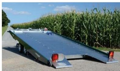
Boden geschlossen mit Aluriffelblech
