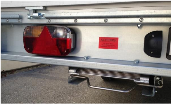
Rampen unter Brücke montiert mit Sicherungsbügel
