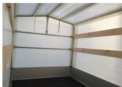
Innenansicht Blachenaufbau Innenhöhe 180cm
