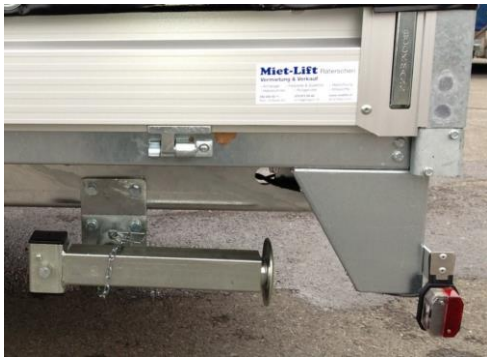
Kurbelstütze, Traglast 1200kg, abschwenkbar
