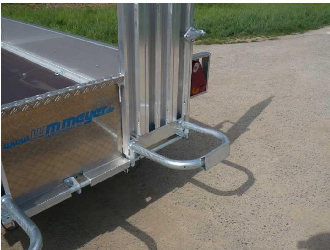
Steckblech zwischen den Rampen
