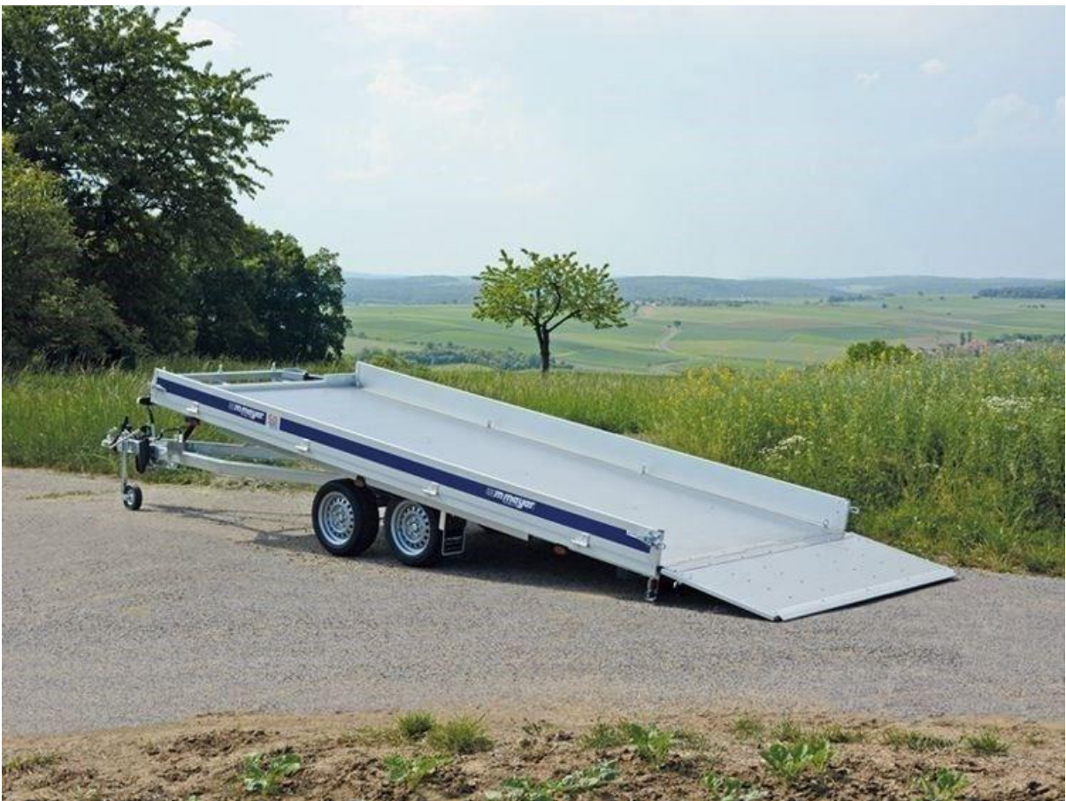
MKHL 3541/202 410 x 202 x 20cm, mit Handpumpe kippbar, Aluoden (Mehrpreis)
