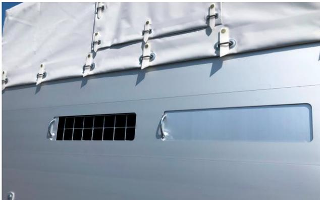
Lüftungsgitter in Stirnwand, Aussenansicht
