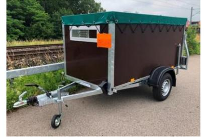
**Kleinviehanhänger Agro** Aufbau aus braunen, wetterfesten Holzplatten, 18mm dick. Fahrgestell verschweisst und feuerverzinkt. Wetterfester Siebdruckboden, Wände aus braunen, wetterfesten Holzplatten, Front gerade. Hinten Heckrampe mit Trittleisten, ohne Hebehilfe. 2 Gitterflügeltüren aus verzinktem Stahl (ohne Treibgitter). Gitterdach mit grüner Abdeckblache. 750kg ohne Bremsen, 1000kg + 1300kg mit Auflaufbremsen und Rückfahrautomatik. Für 100 km/h zugelassen.
