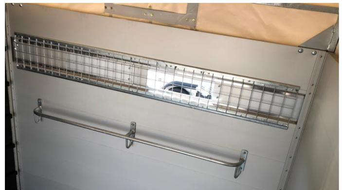
Lüftungsgitter in Stirnwand, Innenansicht
