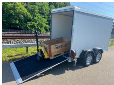
Kombirampe mit Anfahrkeil und Silikon-Antirutschbeschichtung
