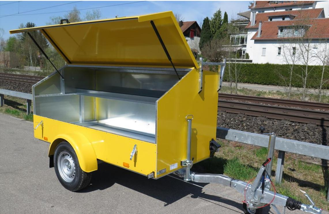
**Werkzeuganhänger Stahlblech lackiert (Farbe wählbar), Aluminiumprofilboden 244 x 110 x 75/110cm. GG 1300kg gebremst**
