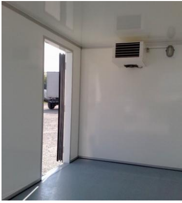
Tiefkühlanhänger mit Seitentüre, 100mm Isowände
