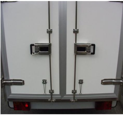
2 Hecktüren mit je 1 Stangenverschluss
