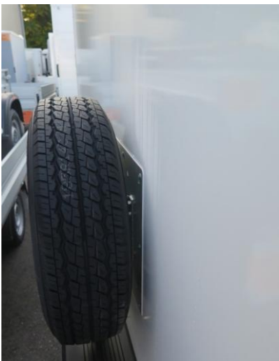
Ersatzrad mit Aluplatte auf Seitenwand
