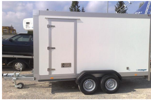
Tiefkühlanhänger mit Seitentüre, 100mm Isowände
