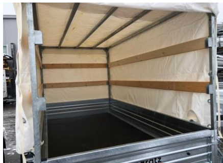
Blachenaufbau, Stahlgestell mit Holzlatten
