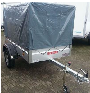
LPA 206 G Innenhöhe 121cm Stirnwand abklappbar
