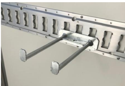
Doppelhaken / Werkzeughaken für Loch-/ Schlitzschiene Stahl feuerverzinkt. Abstand Mitte Haken 100mm, Hakenlänge 210mm
