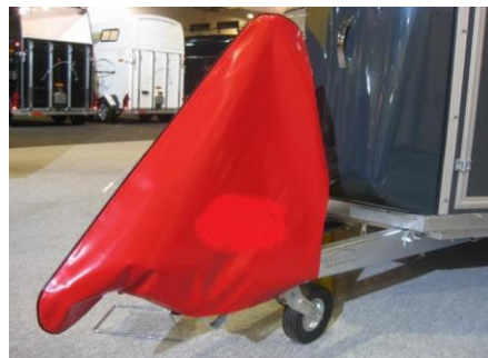
Schutzhaube über Stützrad und Kupplung
