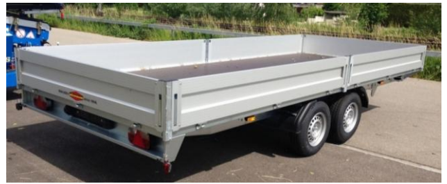
ab 514cm Länge mit geteilten Wänden, Mittelpfosten
