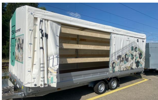
Blachenaufbau mit Schiebeblache, HL-AL 6221/35 Blachenbeschriftung auf Anfrage
