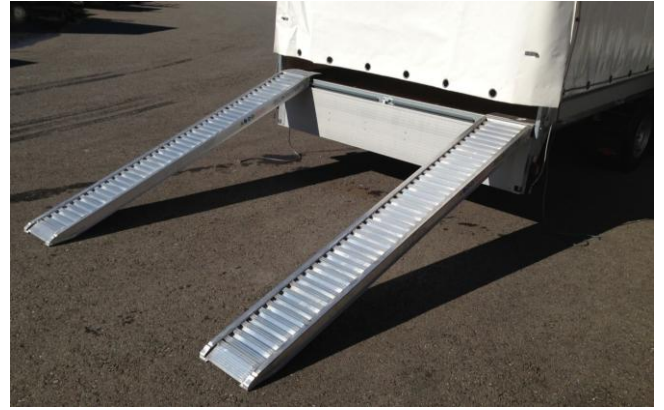
Aluminium-Auffahrrampe (unter Brücke gelagert)
