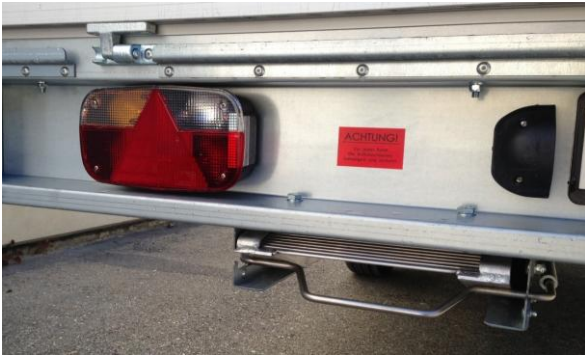
Rampen unter Brücke mit Sicherungsbügel
