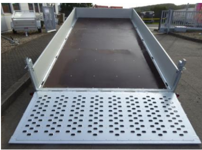
Reling statt Aluwände, Aluriffelblech auf Holzboden
