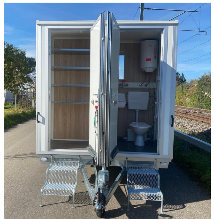
Werkzeugabteil, WC mit Wasserspühlung, Boiler, Zerhacker
