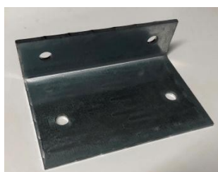
Befestigungsplatte für Klemmschelle Stahl verzinkt. Länge 150mm, Breite 100mm Winkel 50mm, Dicke 5mm. Lochabstand 105mm Lochabstand 105mm, Lochgrösse 11mm. Miet-Lift Art. Nr. 52128
