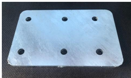
Befestigungsplatte für Kurbelstützen Stahl feuerverzinkt. Länge 206mm, Breite 134mm, Dicke 8mm. Lochabstand Breite 80mm, Länge 0/65/145mm, Lochgrösse 13mm Für Böckmann Hochlader HL-AL Miet-Lift Art. Nr. 52248
