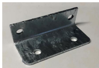
Befestigungsplatte für Flanschplatte Kurbelstützen, Stahl verzinkt. Länge 140mm Breite 65mm / 50mm, Lochabstand 110mm / 80mm
