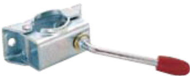
Klemmschelle ø 48mm Knebelschraube starr, verlängerter Knebel Tragfähigkeit max. 200kg
