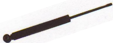
ALKO Auflaufdämpfer 2.8VB 351Z Gesamtlänge 605mm, Rohrlänge 440mm Durchmesser 29mm, Lochdurchmesser M14 Nr. 21726604 Miet-Lift Art.Nr. 53412
