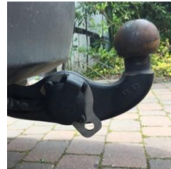
Abreisshalter "Hollandöse" passend zu bestimmten Kupplungstypen je nach Automodell
