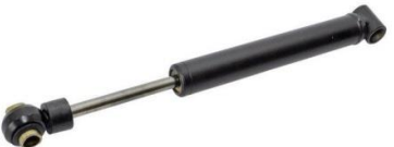
Auflaufdämpfer AL-KO 251G L = 325mm, Rorhl.= 265mm, Rohrdurchm. 29mm (372641) Miet-Lift Art.Nr. 53413
