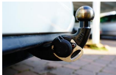
Abreisshalter "Hollandöse" passend zu bestimmten Kupplungstypen je nach Automodell
