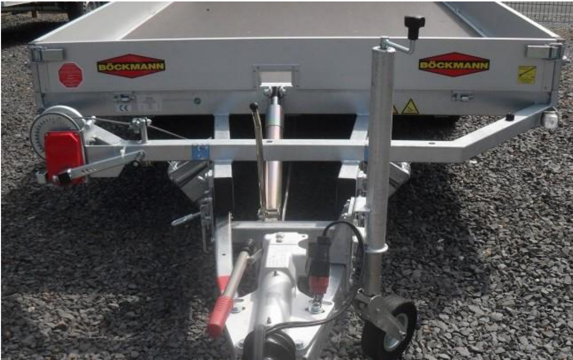
Handseilwinde mit Umlenkrolle, 3-fach vertellbar
