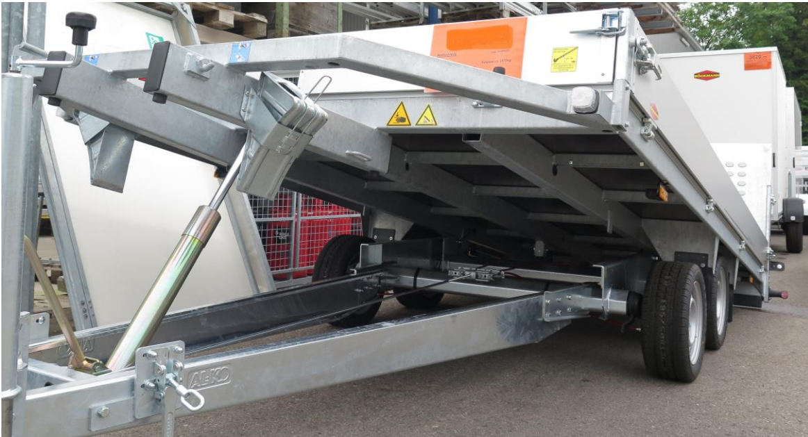
Starke Längsträger und Querprofile für hohe Punktbelastung
