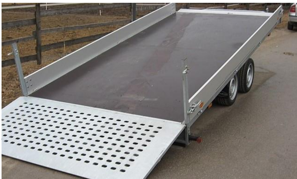
MH-AL 4320/35, verzinkte Stahl-Lochprofilrampe, Bordwände 15cm
