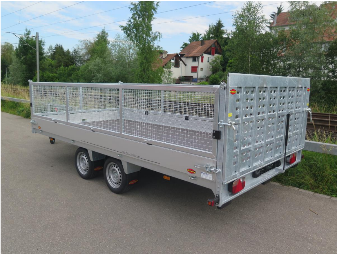
MH-AL 5020/35, Bordwände 15cm mit Laubgitter 60cm
