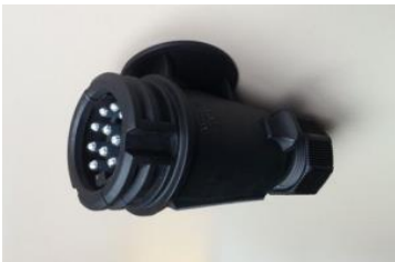
Stecker Kunststoff 13-polig 12V steckbar (nicht zum Eindrehen) mit 13 Schraubanschlüssen Ausgangdichtung für ein Rundkabel
