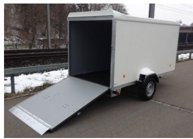
Standardrampe, Überwurfblech am Rampenende
