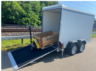
Kombirampe mit Anfahrkeil und Silikon-Antirutschbeschichtung
