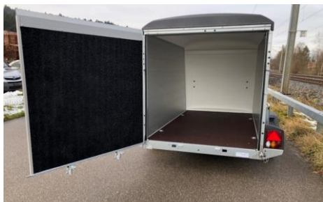
Kombirampe mit Anfahrkeil und Silikon-Antirutschbeschichtung
