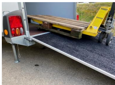
Standardrampe, Überwurfblech am Rampenende
