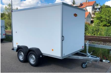
Serie KT Plywood-Holzwände, Polyesterdach Flügeltüren
