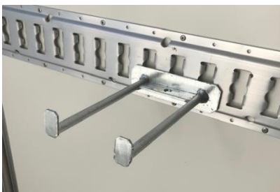
Doppelhaken / Werkzeughaken für Loch-/ Schlitzschiene Stahl feuerverzinkt. Abstand Mitte Haken 100mm, Hakenlänge 210mm Miet-Lift Art.Nr. 58195
