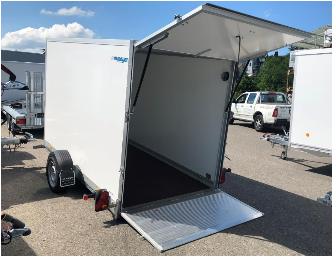
Aluminiumprofilrampe 900kg belastbar, oben Klappe mit Hebedämpfer
